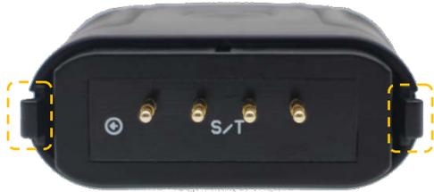
在拔插测试头连接线时，先按住测试头的卡扣，水晶头松动后再拔出连接线。
